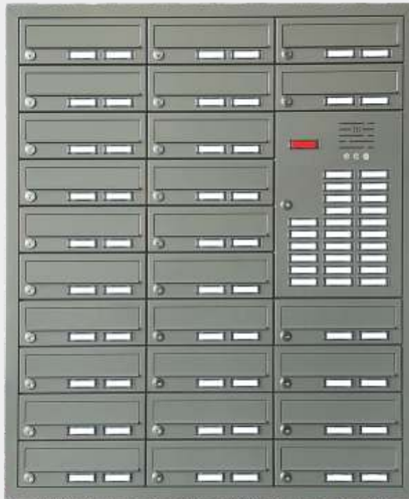
Beispielmodell 26/3 mit 26 Wohneinheiten, RAL 9007 graualuminium Abbildung zeigt: Kastenmaß (HxBxT) 110 x 300 x 380 mm Türanschlag DIN Rechts, ANP Kombiflächentaster schwarz (Bild 18/1) Sprechlochung (Abb.18/7), 2.Namensschild ANPL (Abb.18/2) Modern Line Abdeckprofil
